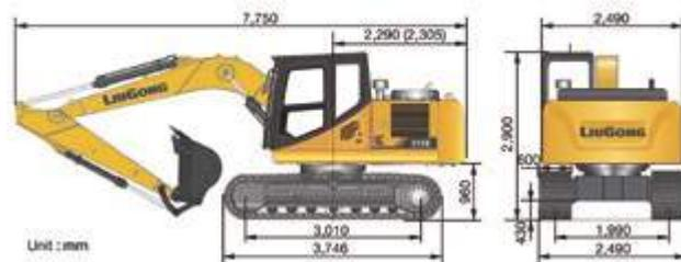
**КОВШ: 0,6 М³, 576 КГ, 4. СТРЕЛА: 4600 ММ, РУКОЯТЬ: 2500 ММ, ШИРИНА БАШМАКА ГУСЕНИЦЫ: 500 ММ, ПРОТИВОВЕС: 2300 КГ**
